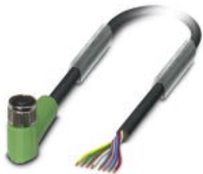
传感器/执行器电缆，8-芯，PUR 无卤素，黑色 RAL 9005，端自由出线，与孔式弯头 M8，电缆长度: 5 m
