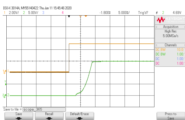
使能起机波形 (正逻辑) CH1: 使能引脚电压 CH2: 输出电压
