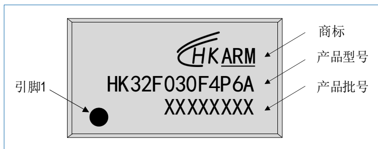
图 7-9 TSSOP20 HK32F030F4P6A 丝印示例
