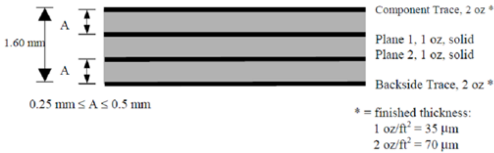
图7-1 JEDEC 标准的 4 层 PCB 参数
