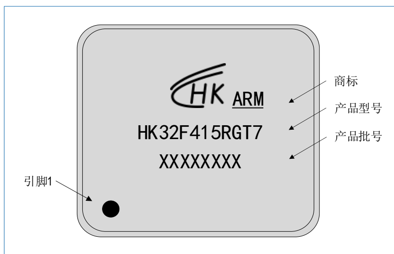
图 7-6 LQFP64 HK32F415RGT7 丝印示例
