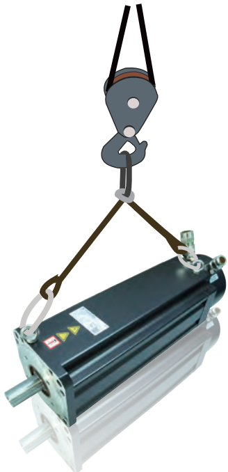
图1 使用吊环和起重梁运输
