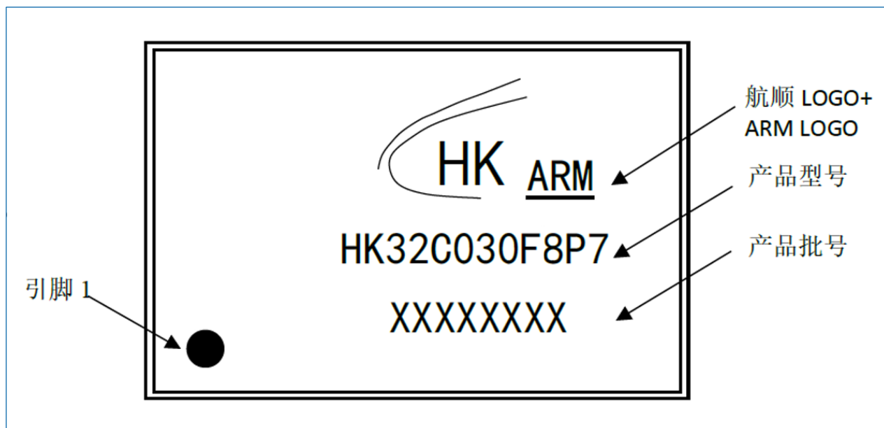
图 7-11 TSSOP20 丝印示例 (HK32C030F8P7)
