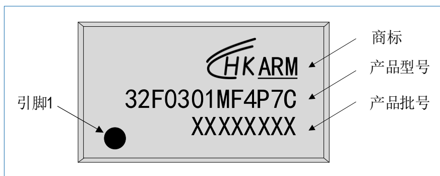
图 7-8 TSSOP20 HK32F0301MF4P7C 丝印示例
