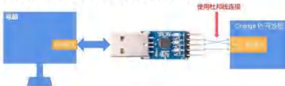
USB转TTL模块连接电脑和 Orange Pi 开发板的示意图
