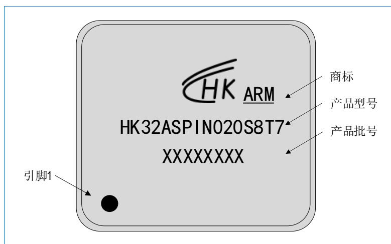
图 7-8 LQFP44 HK32ASPINO20S8T7 丝印示例
