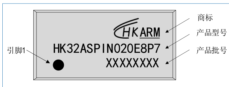
图 7-13 TSSOP24 HK32ASPIN020E8P7 丝印示例
