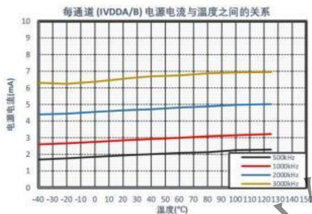
图 9 动态电源电流(IVDDA/B)与温度之间的关系
