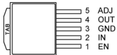
5-Pin TO-252 (D-Pak) Adjustable Voltage (D) MIC29152
